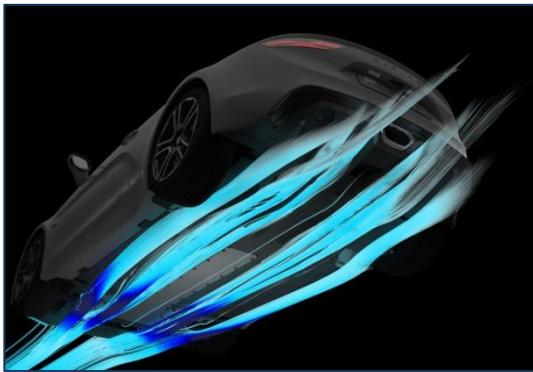
. La nouvelle Alpine disposera d'un fond plat et d'un diffuseur arrière lui conférant une aérodynamique remarquable. La maîtrise des flux d'air est un facteur clé de la performance et de l'efficacité de la future Alpine de route. L'efficacité aérodynamique obtenue permet de se passer d'un aileron arrière et préserver ainsi une ligne pure et fluide, tant appréciée des amoureux de l'A110.
