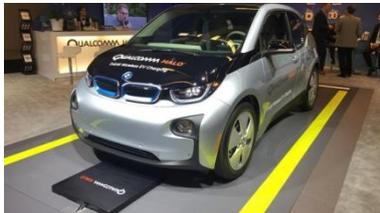
. Sur recommandation de la SAE, les constructeurs, équipementiers et spécialistes technologiques du monde entier se sont mis d'accord sur les principaux éléments techniques et sur les procédures concernant la recharge sans fil WPT (Wireless Power Transfer) et le positionnement en stationnement des véhicules électriques. Cette standardisation a pour but de voir se multiplier le nombre des stations de recharge qui reste à ce jour un des derniers freins au passage au "tout électrique"
