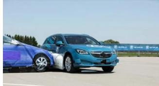
L'équipementier allemand ZF a présenté un concept d'airbag latéral extérieur visant à prévenir les dommages aux véhicules et aux passagers en cas de choc latéral. Lorsqu'une collision latérale imminente est détectée par les capteurs du véhicule, le coussin d'air de 400 litres sort de son logement sous le plancher en 150 millisecondes pour absorber une partie de l'énergie du choc. La gravité de l'impact pourrait ainsi être réduite de 40%.
