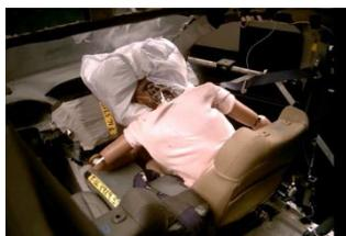
Honda a annoncé le mois dernier qu'il allait commencer à installer « une nouvelle technologie innovante d'airbag frontal passager » dans les nouveaux véhicules à partir de 2020. Cet airbag, comme le montre la vidéo, est beaucoup plus enveloppant qu'un airbag traditionnel : il empêche le passager de se déplacer latéralement lors de la phase de retour vers le siège et il protège également les épaules.
