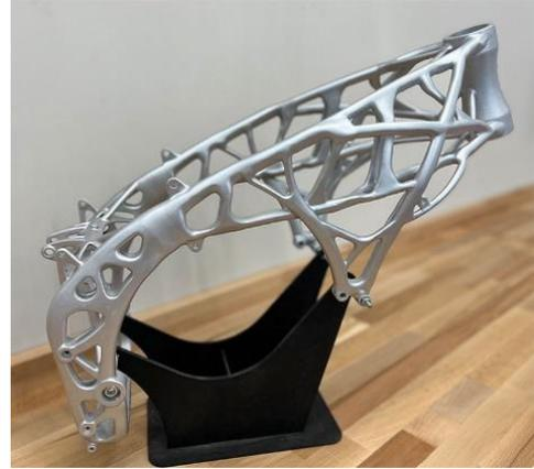
En associant les développements de conception intelligente et l'expérience des véhicules de compétition de l'Université de Nebrija à la puissance de R&D et à la technologie de fabrication additive d'ArcelorMittal, le projet a établi une nouvelle méthode de fabrication d'un cadre en treillis d'acier tubulaire : l'impression 3D.
